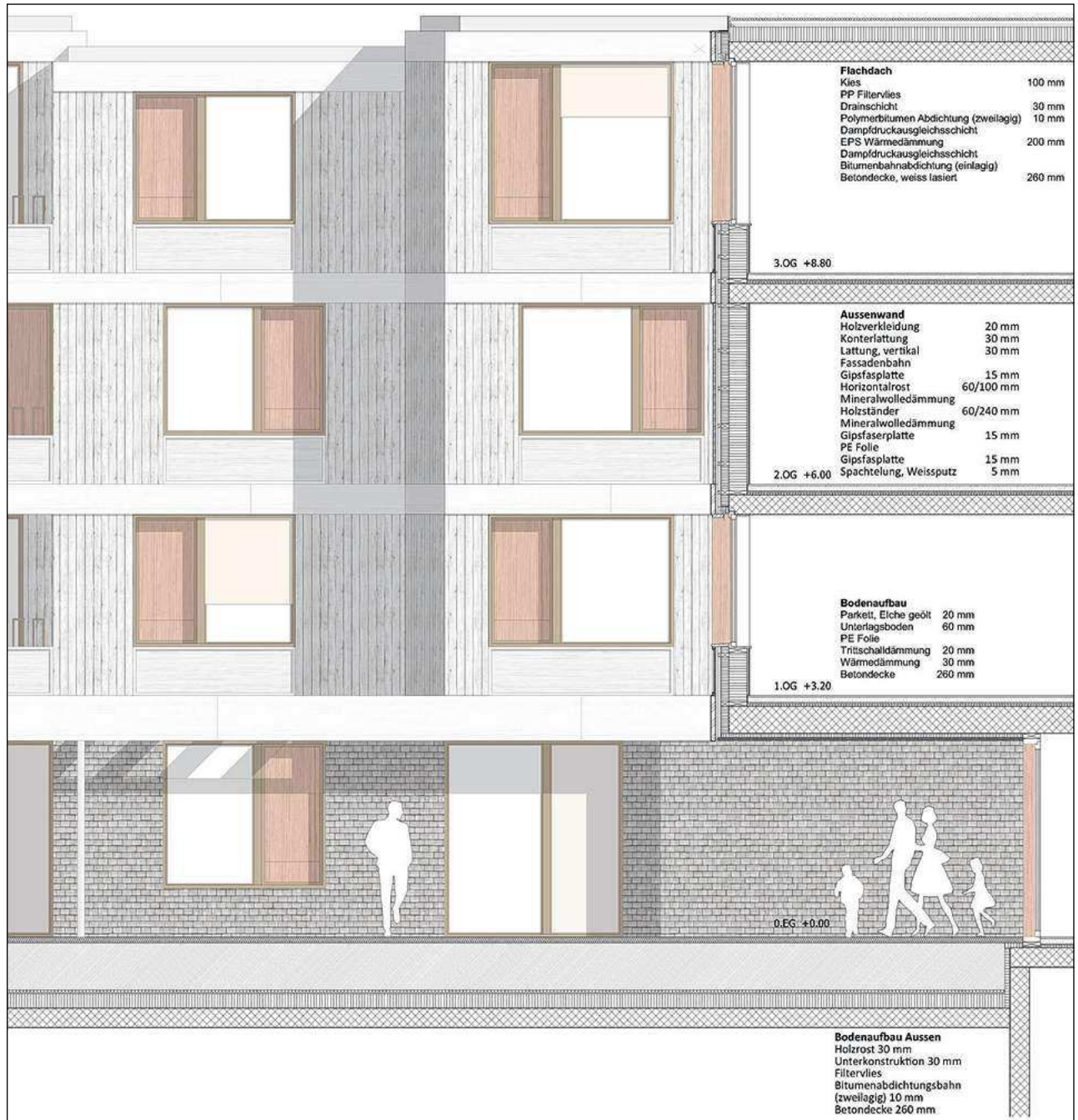
Konstruktion und Materialität. (Bild: BGP Architekten)
